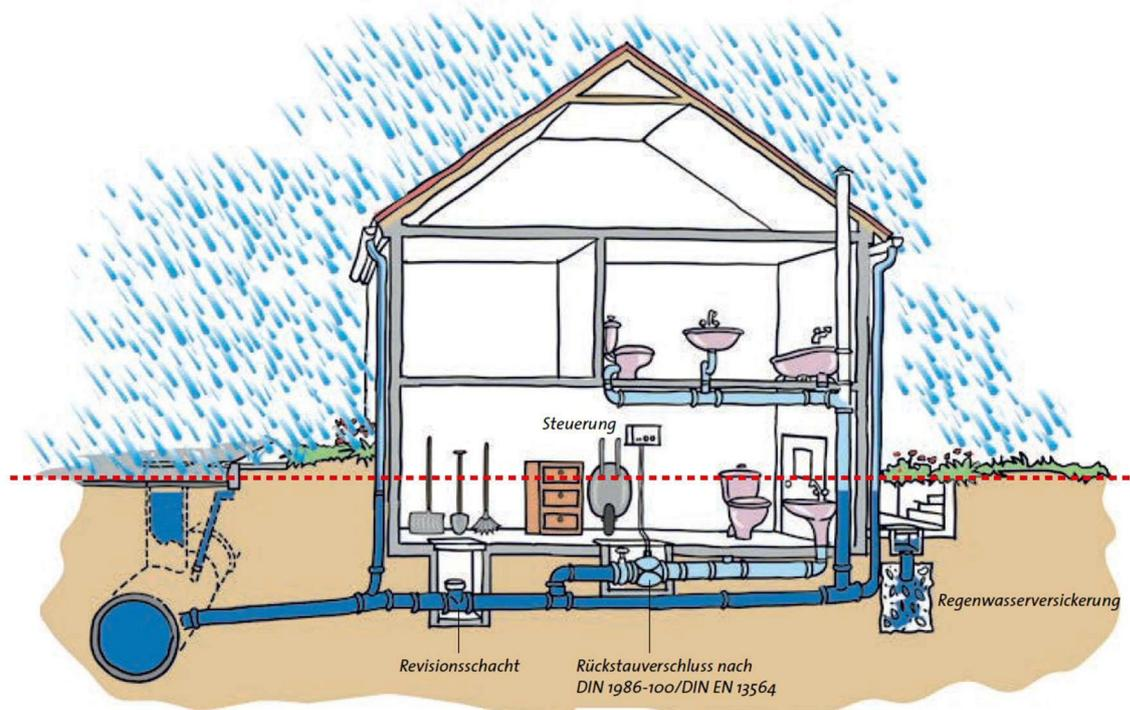
**Abb. 8.1 Rückstaugesichertes Haus durch Rückstauverschluss bei Starkregen.**
