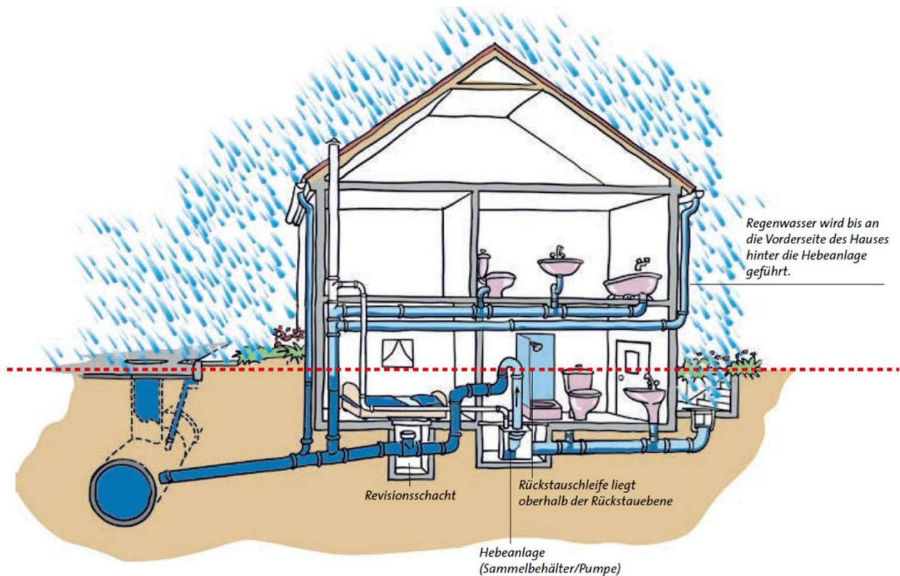
**Abb. 6.1 Rückstaugesichertes Haus bei Starkregen – durch eine Hebeanlage geschützt**
