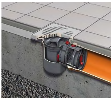
Abb.3 Bodenablauf mit integriertem mechanischen Rückstauverschluss – nur bei fäkalienfreiem Abwasser zulässig
