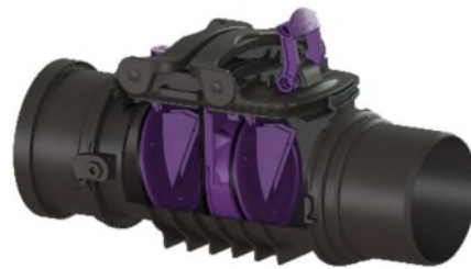
Abb.2 Mechanischer Rückstauverschluss mit zwei selbsttätigen Verschlüssen – nur bei fäkalienfreiem Abwasser zulässig.
